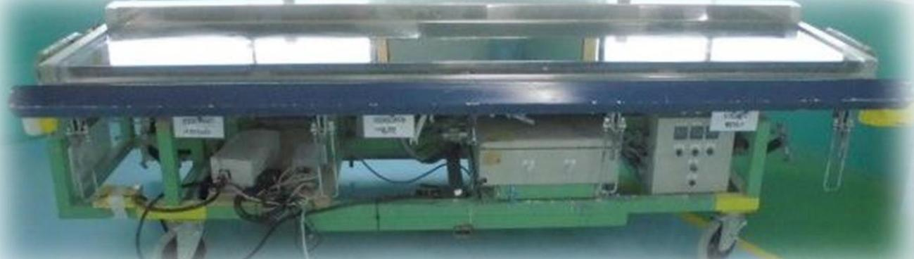
※型内部にセンサーが埋め込まれているので、専用の制御盤にて簡単に温度設定・温度管理が可能です。
