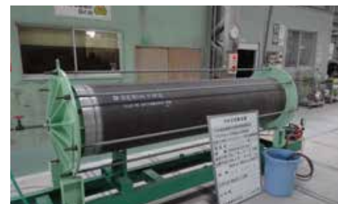
内水圧試験状況写真 小口径管
